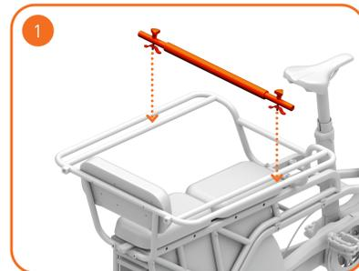
1 Positionieren Sie die vormontierte Space Bar auf der Ride-Bar. Achten Sie darauf, dass die Klammern zwischen den Außen- und Innenstreben positioniert sind.
